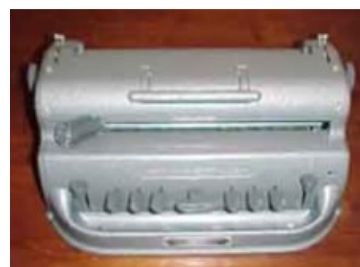
MÁQUINA PERKINS - Possui seis teclas que representam os pontos da célula braille
