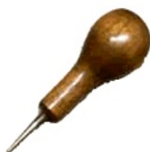
PUNÇÃO - Objeto utilizado para a perfuração de pontos na estruturação da escrita
