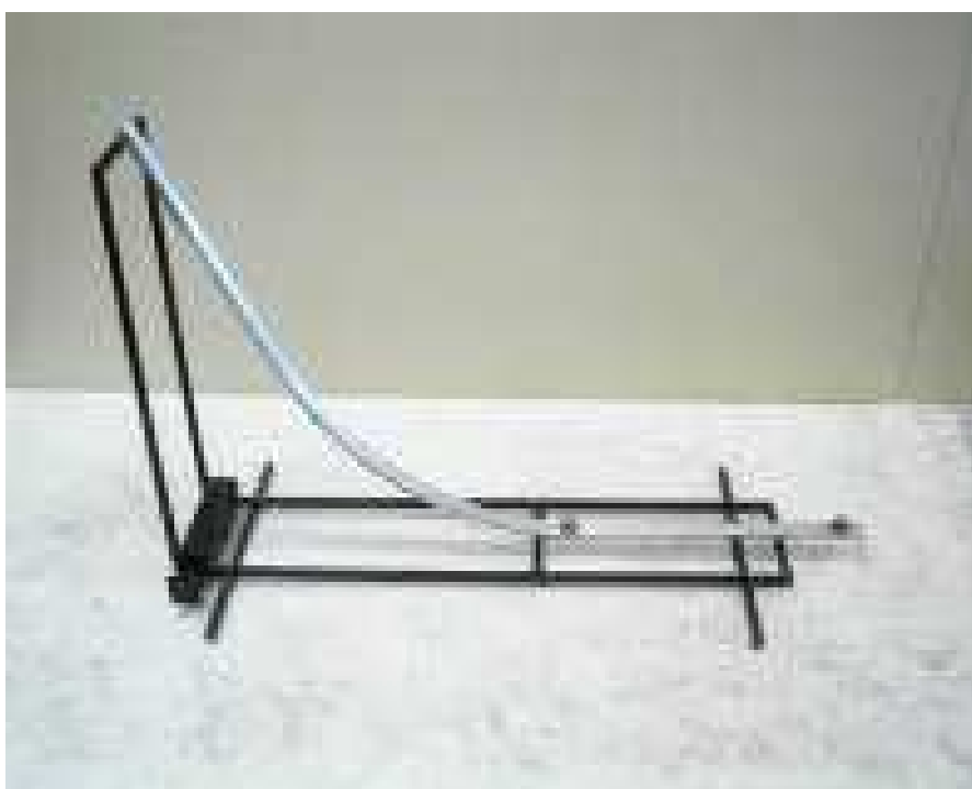
Figura 7 – Trilho para estudo das colisões e lançamento horizontal – utilizado para o estudo da conservação da quantidade de movimento em colisões, conservação da energia mecânica nos lançamentos lançamento horizontal
