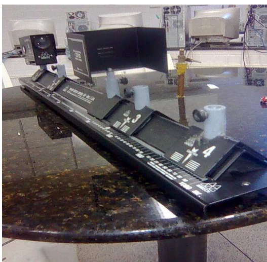
Figura 11 - Banco Óptico para estudo das imagens em espelhos e lentes
