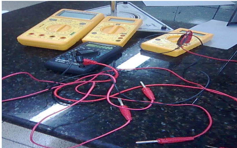
Figura 05 – Medidores elétricos para Tensões, Resistências, Potências e Intensidades de Corrente elétrica
