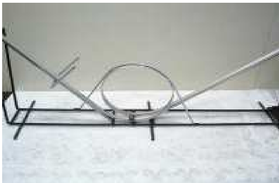
Figura 09 – Looping – utilizado para o estudo da força centrípeta, da conservação da energia mecânica e da quantidade de movimento.
