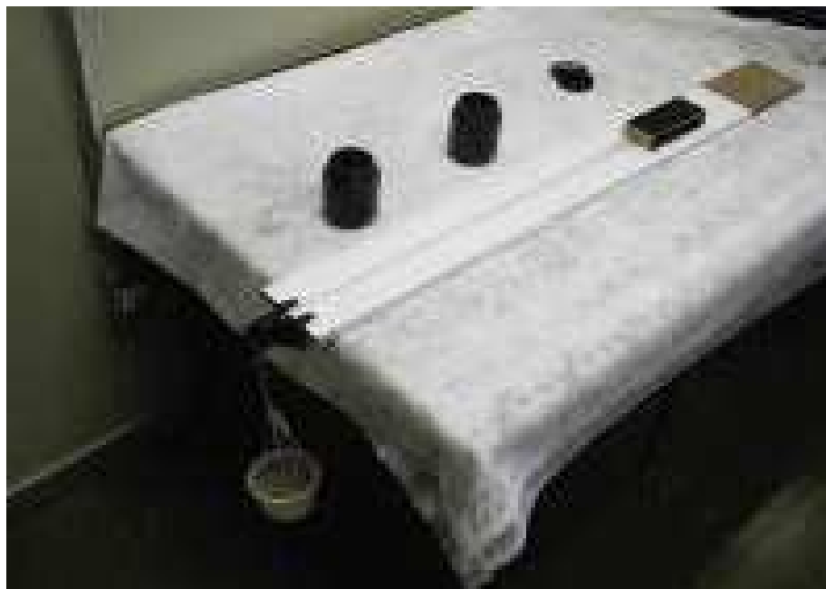
Figura 8 – Kit experimental utilizado para o estudo da força de atrito
