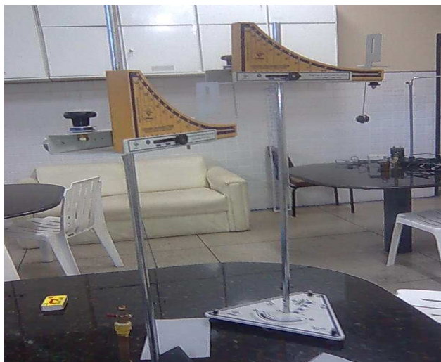
Figura 10 - planos inclinados para estudo de lançamento horizontais utilizando a conservação da quantidade de movimento e conservação de energia
