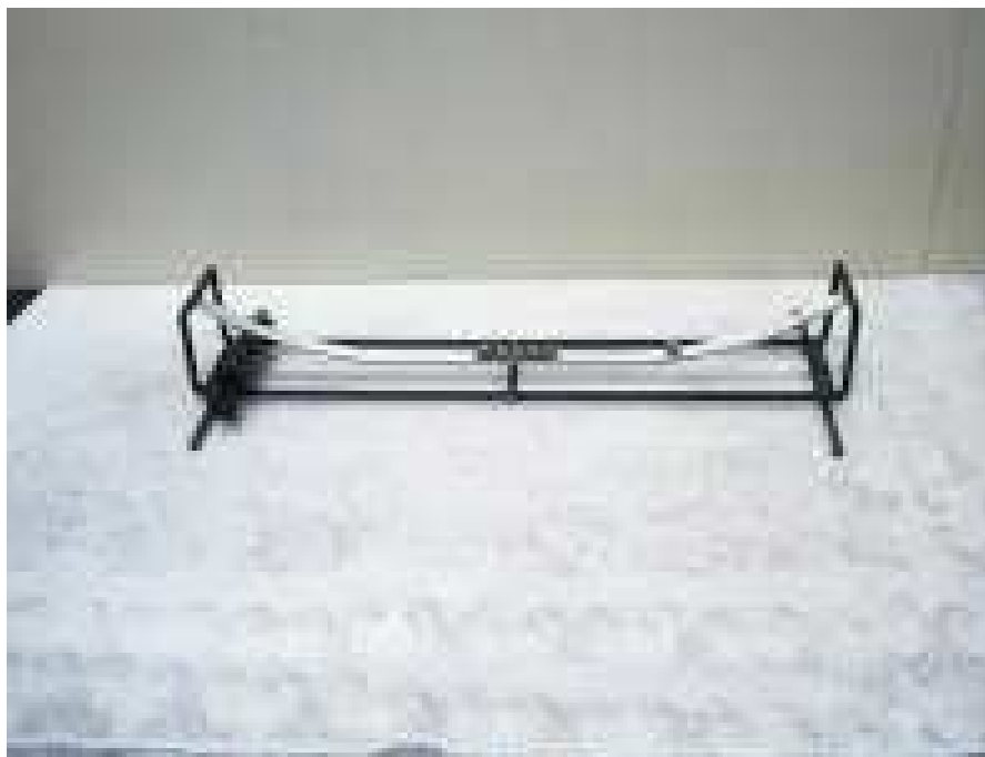
Figura 6 – Trilho para colisões – utilizado para o estudo da conservação da quantidade de movimento.
