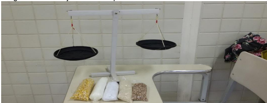
Figura 14 - Balança construída para trabalhar sistema de medida de massa.
