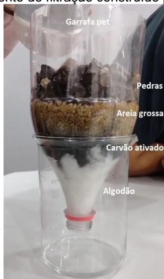
Figura 12 - Equipamento de filtração construído pelos alunos
