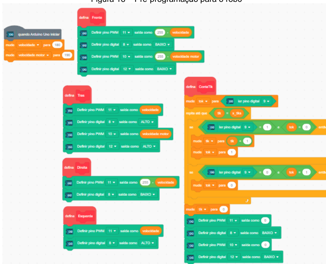
Figura 16 – Pré-programação para o robô
