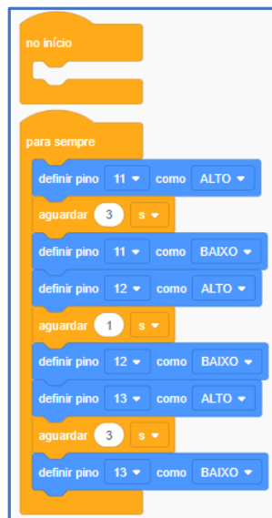
Figura 71 – Solução do problema do semáforo com a construção em blocos de comando
